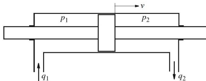
nel quale  $p_1$ ,  $p_2$ ,  $q_1$  e  $q_2$  sono le pressioni e le portate dell'olio nelle due parti del cilindro, mentre  $v$  è la velocità di moto del pistone. Considerando  $q_1=q_2=u$  (variabile manipolabile), il modello matematico del sistema può essere descritto tramite le seguenti equazioni differenziali:
