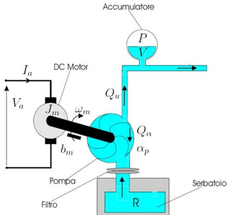
Applicando le opportune leggi fisiche per il circuito di tipo RL del motore e per la dinamica del fluido attraverso la pompa e l'accumulatore, il modello matematico del sistema può essere descritto tramite le seguenti equazioni differenziali:
