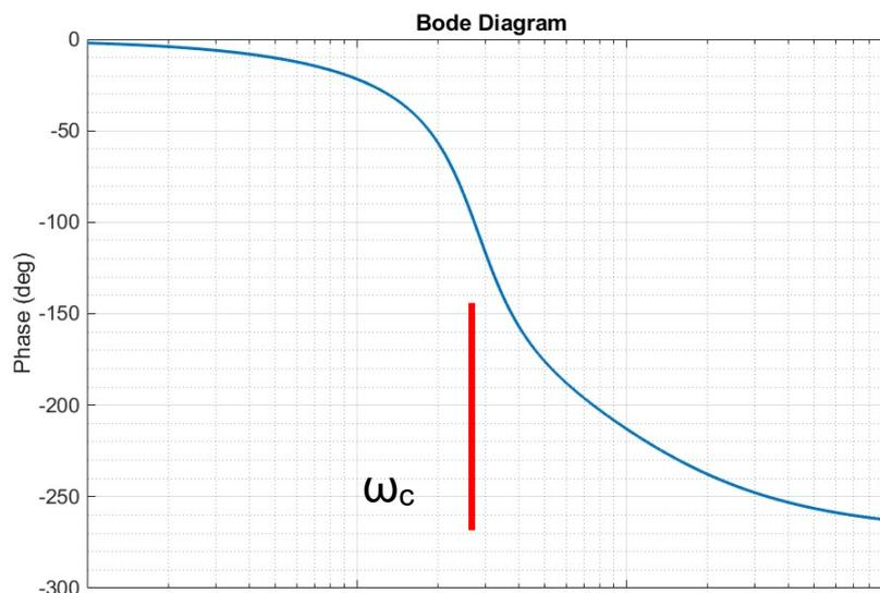
pertanto il margine di fase (i.e.  $-180^\circ = \arg[G(j\omega_c)] - M_f \rightarrow M_f = \arg[G(j\omega_c)] + 180^\circ$ )
