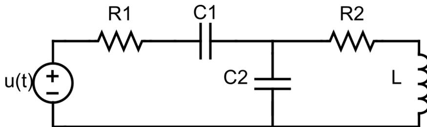
Indicando con  $x_1$ ,  $x_2$ ,  $x_3$  rispettivamente la tensione ai capi del condensatore  $C_1$ , la tensione ai capi del condensatore  $C_2$  e la corrente nell'induttore  $L$ , il modello matematico del circuito si può ottenere applicando le leggi di Kirchhoff e le relazioni di base di elementi elettrici passivi, dalle quali derivano le seguenti equazioni differenziali:
