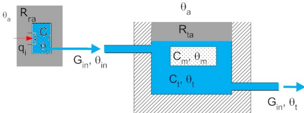
Indicando con  $\theta_m$ ,  $\theta_t$ ,  $\theta_{in}$  rispettivamente la temperatura del metallo, quella del contenitore principale e quella del fluido in ingresso a quest'ultimo, il modello matematico del sistema si può esprimere con le seguenti equazioni (nell'ipotesi che la temperatura ambiente sia nulla):
