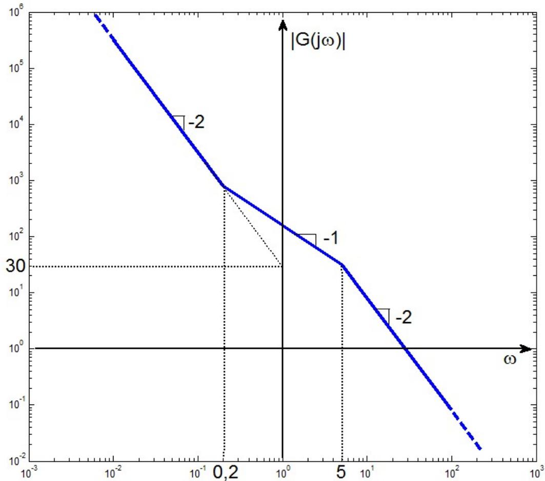
si determinino i parametri della funzione di trasferimento  $G(s)$ , supposta a fase minima ed espressa con la seguente fattorizzazione:
