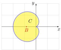
Calcoliamo il momento di inerzia di C rispetto al suo baricentro; si tratta di calcolare l'integrale del quadrato della distanza di un punto generico dal baricentro  $B = (x_B, y_B)$ ,
