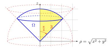
In coordinate sferiche, la regione  $\Omega$  corrisponde alle condizioni  $0 \le r \le 3$  per la palla, e  $0 \le \varphi \le \frac{\pi}{4}$  per il cono. Inoltre ricordiamo che  $\sqrt{x^2 + y^2} = \rho = r \sin \varphi$ . L'integrale diventa
