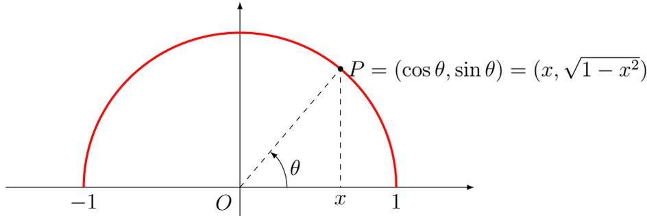
Possiamo parametrizzare un generico punto  $P$  della semicirconfenza usando come parametro l'angolo  $\theta \in [0, \pi]$  che il segmento  $OP$  forma con il semiasse positivo delle ascisse, oppure usando come parametro l'ascissa  $x \in [-1, 1]$  del punto  $P$ . Otteniamo così due possibili parametrizzazioni della stessa semicirconfenza,
