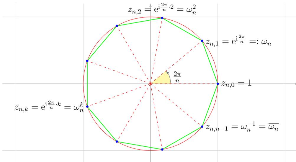
Siano  $z_{n,k}$ , con  $k = 0, 1, \dots, n-1$ , le  $n$  radici  $n$ -esime di 1, enumerate al variare di  $k$  in senso antiorario, a partire da  $z_{n,0} = 1$ . Per passare da una radice alla successiva basta fare una rotazione di un angolo pari all' $n$ -esima parte dell'angolo giro; gli argomenti di queste radici saranno dunque tutti multipli interi di  $\frac{2\pi}{n}$ . In notazione esponenziale avremo:
