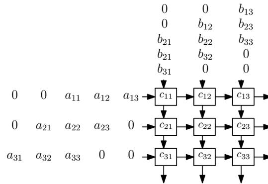
I dati in ingresso vengono letti da una RAM e inseriti in FIFO (shift-register) prima dell'elaborazione. I processing element (i quadrati) moltiplicano i valori che hanno in input e li sommano a un valore accumulato in precedenza. Poi passano i valori di B ai processing element di sotto e quelli di A a quelli a destra (a parte gli ultimi). Alla fine, gli elementi contengono la matrice prodotto che comunque deve poi essere scritta in RAM.
