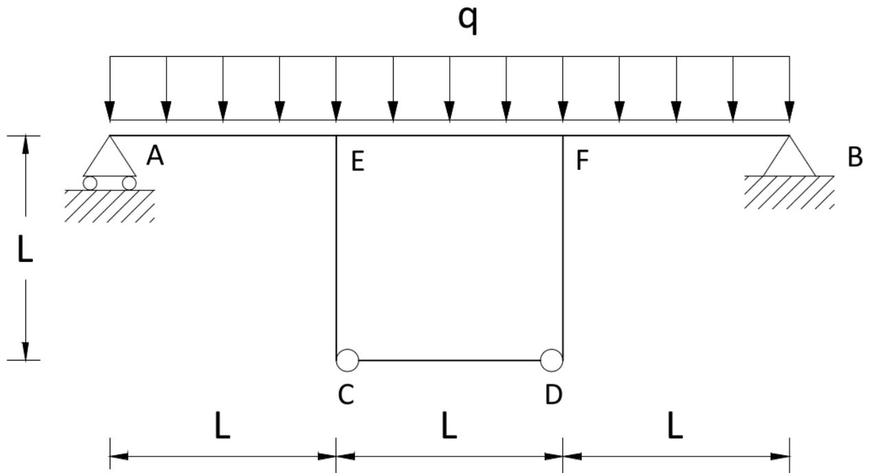
Si determinino i diagrammi delle azioni interne della struttura in figura assumendo  $q=2 \text{ KN/m}$  e  $L=3 \text{ m}$ . Si trascuri la deformabilità assiale delle travi.
