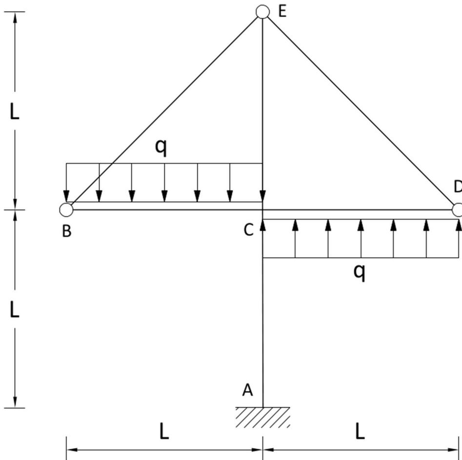
1) Si determinino i diagrammi delle azioni interne MNT della struttura antisimmetrica in figura. Si assuma per i calcoli  $q=1000 \text{ N/m}$  ed  $L=3 \text{ m}$ .
