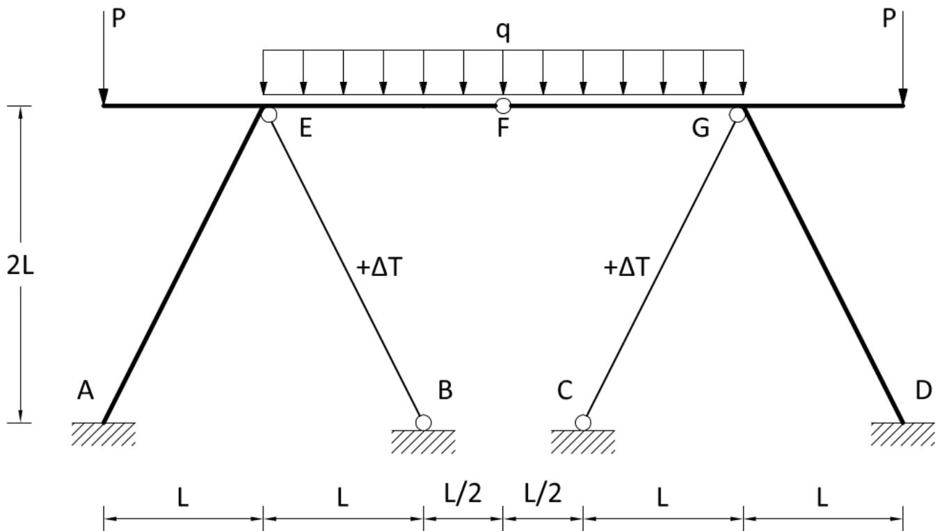
1. Risolvere la struttura in figura mediante il metodo delle forze avendo posto  $L=3\text{m}$ ,  $q=3000\text{ N/m}$  e  $P=q/2$ . Si trascurino in questa fase i carichi termici e la deformazione assiale di tutte le aste.
