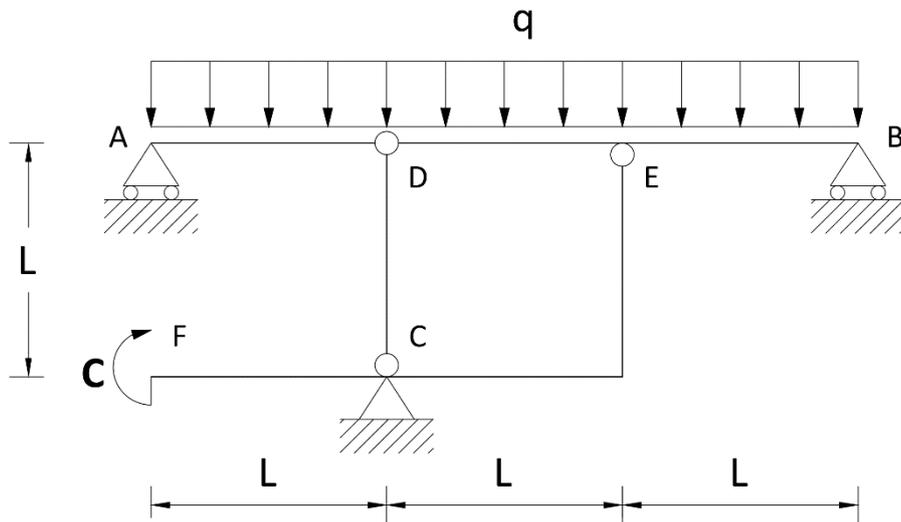
2) Determinare i diagrammi quotati MNT della struttura in figura, con  $q=500 \text{ N/m}$ ,  $C=qR^2$ ,  $R=3 \text{ m}$
