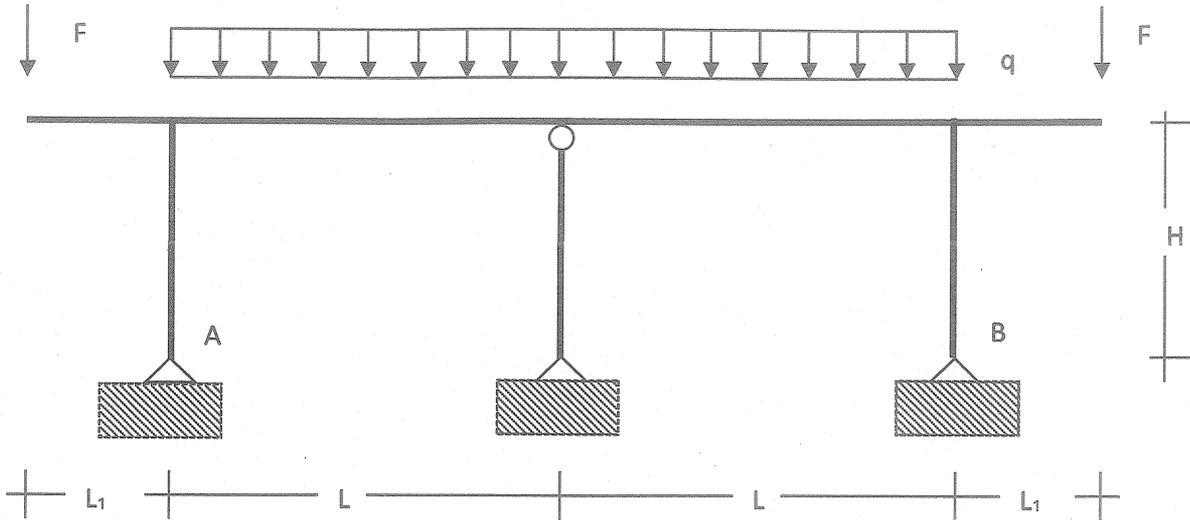
Si trascuri la deformabilità assiale della struttura.
