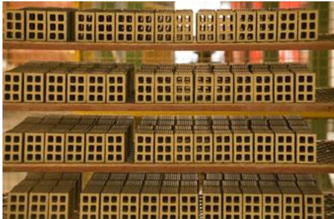
4. **ESSICCAZIONE** avviene in essiccatoi artificiali, alimentati con aria calda recuperata dal forno di cottura o prodotta da una sorgente di calore.
