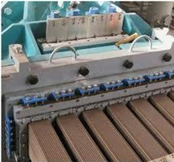
**3. FORMATURA** Si utilizza una mattoniera, dove l'argilla, ancora umida, viene estrusa attraverso una filiera, cioè pressata e fatta uscire da un orificio che ha la sezione del pezzo che si vuole produrre. Un'apposita taglierina suddivide il filone continuo d'argilla nei singoli mattoni della misura desiderata.
