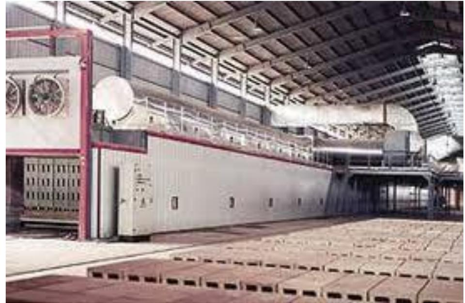
5. **COTTURA** Il passaggio finale del ciclo produttivo è la cottura, che avviene all'interno di un forno, cosiddetto a tunnel: usciti dal forno i mattoni sono pronti per l'imballaggio.
