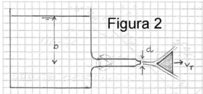
Dati numerici:  $d = 50 \text{ mm}$ ;  $b = 5 \text{ m}$ ;  $v_T = 4 \text{ m/s}$
