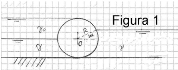
Una paratoia cilindrica ha sezione circolare di raggio  $R$  e lunghezza  $L$ . E' bagnata da due liquidi (strati di uguale spessore  $R$ ) a monte (un olio di densità relativa  $r_0$  e acqua) e soltanto da acqua a valle. La geometria del problema è descritta in Fig. 1. L'angolo  $\alpha$  individua la superficie libera a valle. Si richiede il calcolo della risultante (modulo, direzione, verso, retta d'azione) delle azioni idrostatiche sulla paratoia.
