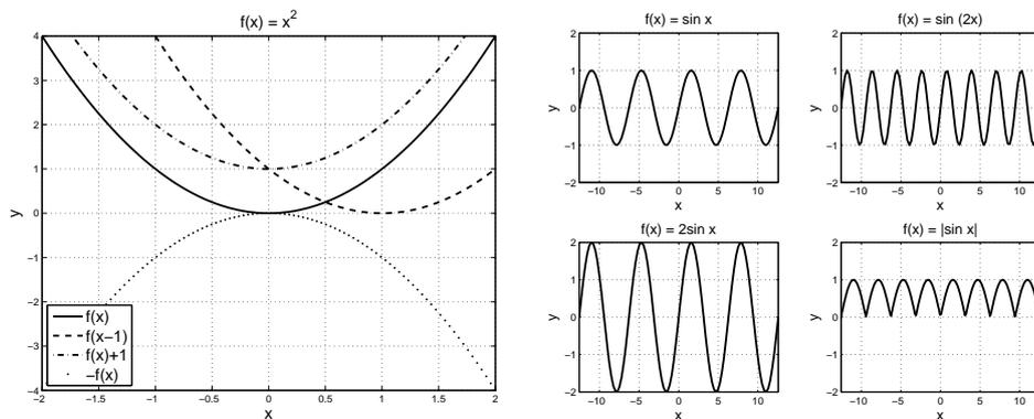
Figura 4.3: A sinistra, la funzione  $f(x) = x^2$  e le funzioni  $f(x - 1)$ ,  $f(x) + 1$ ,  $-f(x)$ . A destra, la funzione  $f(x) = \sin x$  e le funzioni  $f(2x)$ ,  $2f(x)$ ,  $|f(x)|$ ; notare che gli assi hanno la stessa scala.
