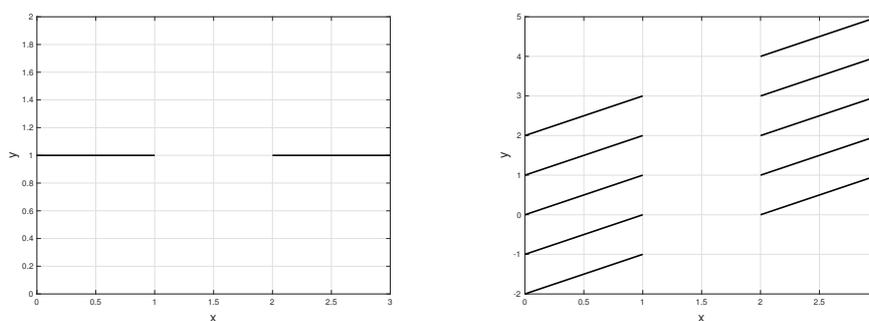
Figura 7.4: A sinistra la funzione  $f(x) = 1$  definita in  $[0, 1] \cup [2, 3]$  e, a destra, alcune delle sue primitive. Più precisamente, ogni funzione rappresentata a destra, il cui grafico sia formato da un qualsiasi tratto nell'intervallo  $[0, 1]$  e da un qualsiasi tratto nell'intervallo  $[2, 3]$ , è primitiva di  $f$ .
