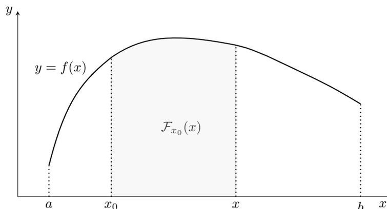
Figura 7.8: La funzione integrale: fissato  $x_0 \in I$ , il valore  $\mathcal{F}_{x_0}(x)$  dà l'area (con segno) della regione di piano compresa tra il grafico di  $f$ , l'asse  $x$  e le due rette verticali passanti per  $x_0$  e  $x$ .
