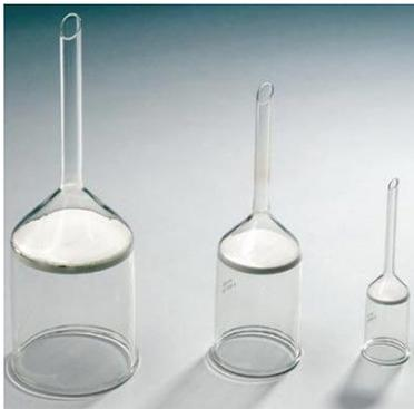
Vetro sinterizzato a porosità variabile: Porosità (diametro del poro maggiore): da P 0 (filtrazioni grossolane), range 250-500  $\mu\text{m}$  a P 5 (filtrazioni batteriologiche), range 1-1.6  $\mu\text{m}$
