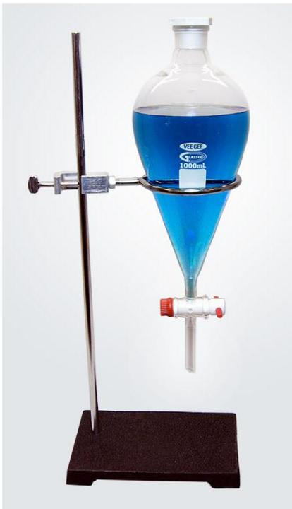
Per eseguire un'estrazione, bisogna prima di tutto scegliere un imbuto separatore che abbia una capacità circa doppia del volume totale di liquido che dovremo usare. L'imbuto va poggiato su un anello fissato con morsetto a un sostegno.
