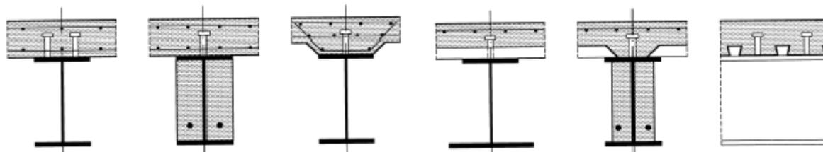
Figura 4.3.3 - Tipologie di sezione composte per travi..
