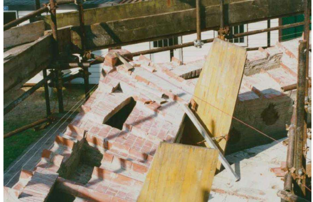
Modello in scala 1:5 della cupola di Brunelleschi in fase di costruzione
