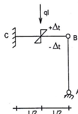
C2) Nella seguente struttura reticolare iperstatica determinare l'incognita iperstatica via PLV.
