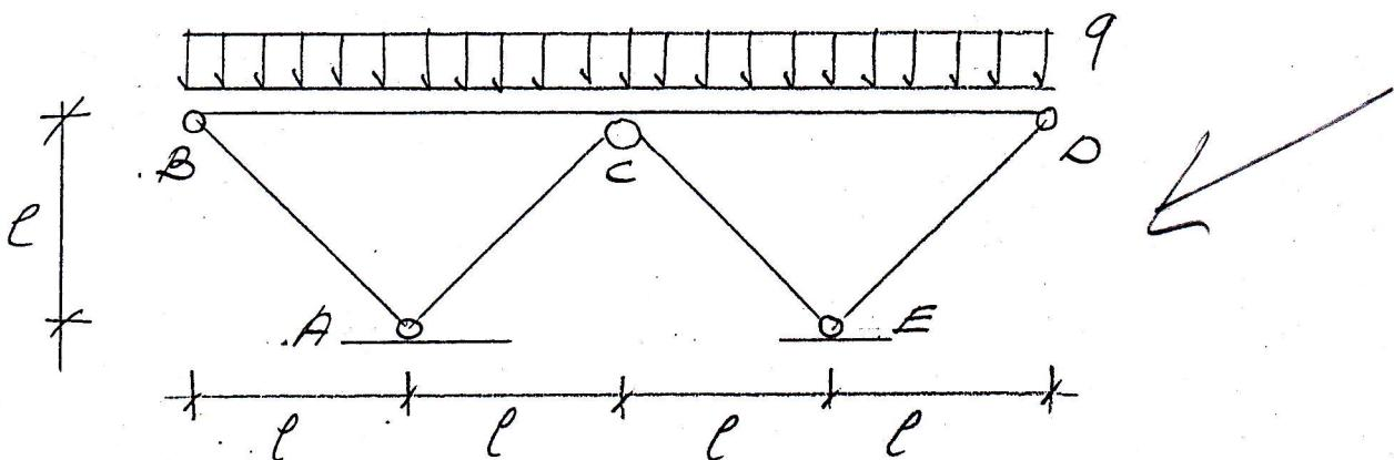
2. Determinare con il Metodo delle Forze la reazione verticale in D nella seguente struttura:
