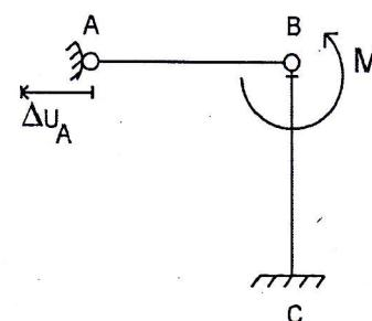
A2) Nella seguente struttura reticolare iperstatica determinare l'incognita iperstatica via PLV.
