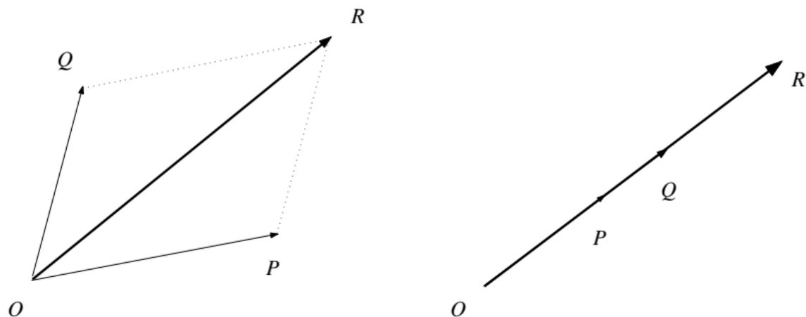
Figura: Regola del parallelogramma (sinistra). Situazione con vettori allineati (destra).
