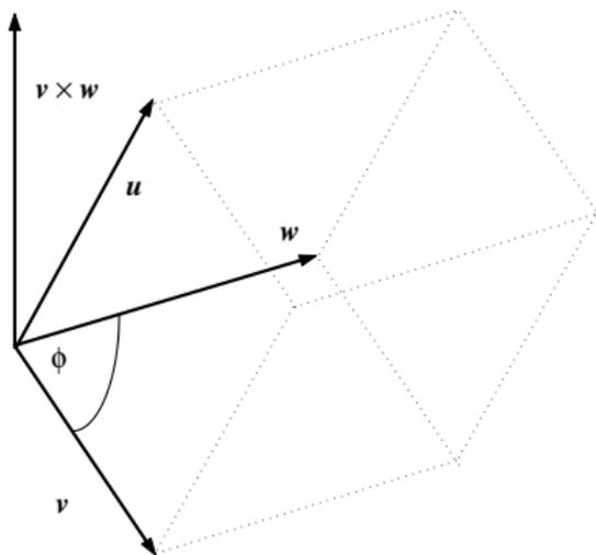
Figura: Prodotto misto e volume del parallelepipedo.
