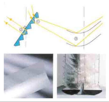
24. Installazione interna mobile: tipologia "veneziana". L'esecuzione, stabilita in prossimità delle superfici trasparenti, considera i dispositivi orientati a riflettere i raggi solari diretti (1) e a trasmettere la luce naturale diffusa (2), mentre le lamelle orientabili, parzialmente perforate, dirigono la radiazione luminosa (3). (produzione Hüppe Form)
