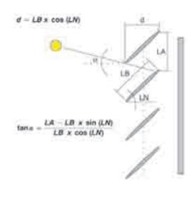
33. Calibrazione esecutiva e regolazione funzionale. L'esecuzione comporta la rilevazione dei principali parametri quali l'estensione delle mensole di supporto (D), l'altezza della superficie trasparente di facciata (h), l'angolo critico di incidenza solare, che determina l'altezza alla quale l'irraggiamento solare dirige l'illuminazione attraverso la superficie trasparente (α).
