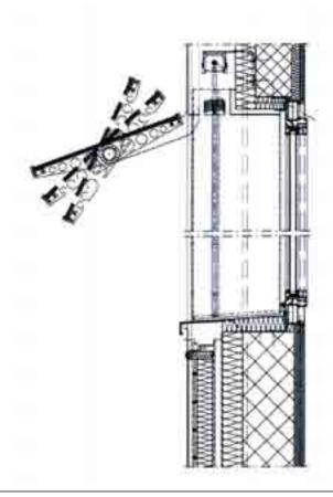
31. Combinazione con moduli fotovoltaici. Le schermature solari dotate delle celle fotovoltaiche prevedono l'assemblaggio mediante i profili a mensola in alluminio, su perni regolabili secondo l'inclinazione dei raggi solari. (produzione Schweizer)
