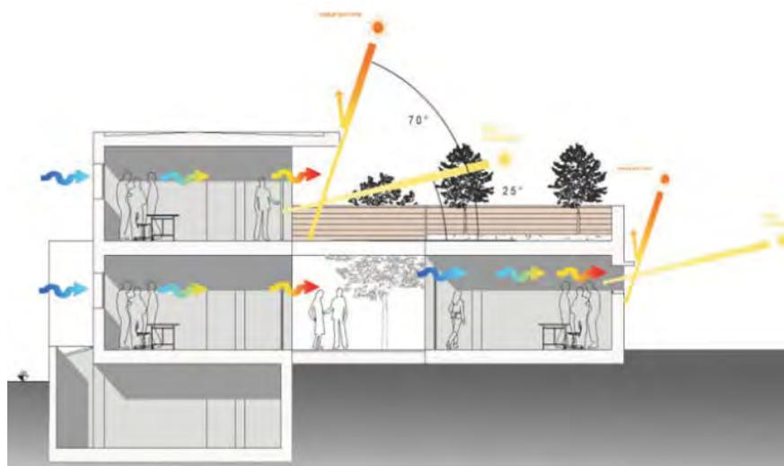
**Le esperienze condotte hanno dimostrato come la percentuale di superficie trasparente negli edifici passivi non debba superare il 40 % di quella complessiva del lato meridionale per non causare perdite eccessive per trasmissione o surriscaldamenti**
