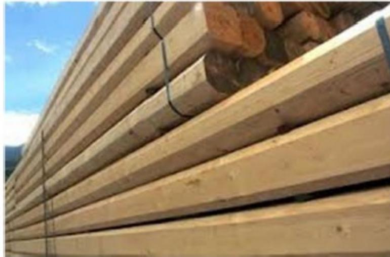
**trave Uso Fiume:** Trave a sezione quadrata o rettangolare ottenuta da un tronco mediante squadratura meccanica, continua e parallela dal calcio alla punta su quattro facce a spessore costante con smussi e contenente il midollo.
