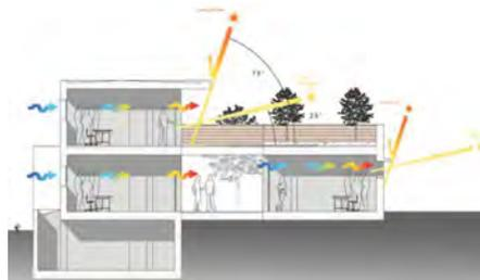
**Le esperienze condotte hanno dimostrato come la percentuale di superficie trasparente negli edifici passivi non debba superare il 40 % di quella complessiva del lato meridionale per non causare perdite eccessive per trasmissione o surriscaldamenti**
