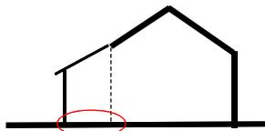
SERRA A SCAMBIO CONVETTIVO indifferentemente a parete o a pavimento. La massa termica a serve prevalentemente a scaldare l'aria nella serra
