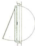
L'ante ribaltabile a 180° permette l'apertura del bilico a vetri di alluminio per le poltrine
