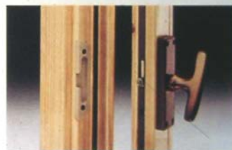
CHIUSURA IN PROFILATO di acciaio trattato, con rotolini a rullo, chiodi terminali e incontri laterali in nylon (a 3 o 4 punti di chiusura).
