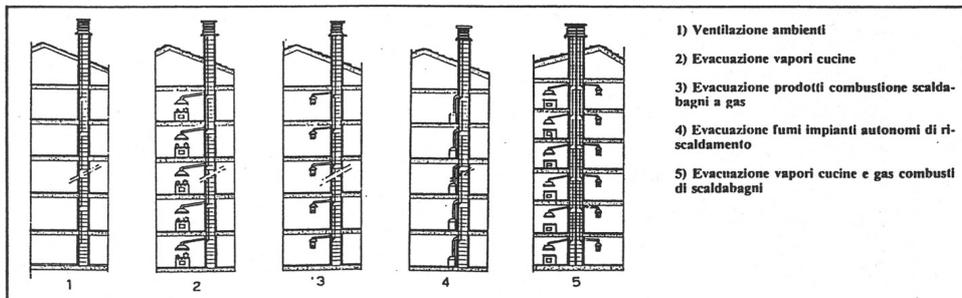
Figura 23. Esempi di corretta installazione di canne fumarie e/o di esalazione (da Corbo L, op.cit.).
