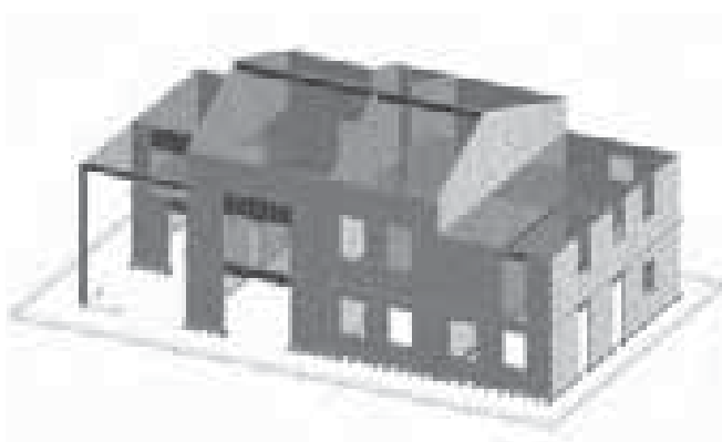
Figura 3.12_Modello numerico per l'analisi dinamica di un edificio a pannelli a strati incrociati.
