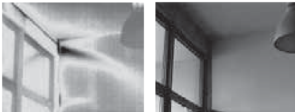
Figura 4.47_Infiltrazione d'aria da infisso in legno, immagine termografica e foto nel visibile [24].
