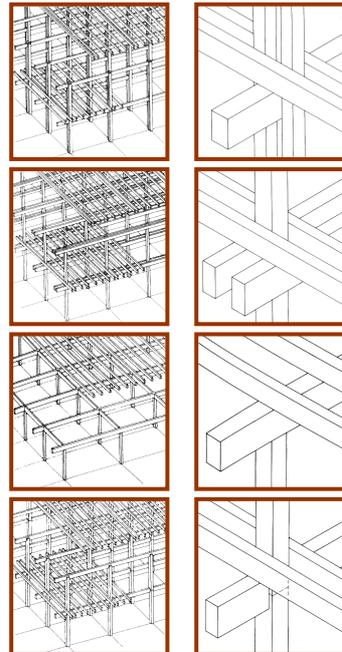
**Struttura con coppie di montanti e trave singola**
