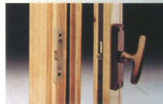
CHIUSURA IN PROFILATO di acciaio trattato, con nottolini a rullo, chiodi terminali e incontri laterali in nylon (a 3 o 4 punti di chiusura).
