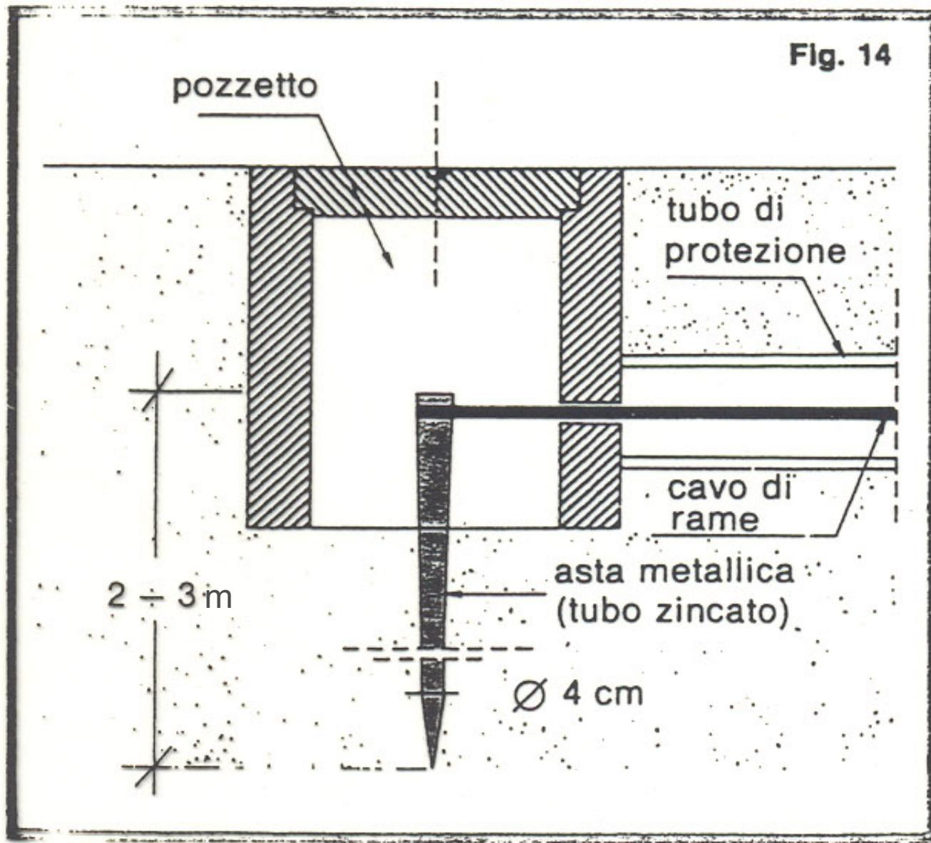
Fig. 14 - Pozzetto con dispositivo di presa di terra.
