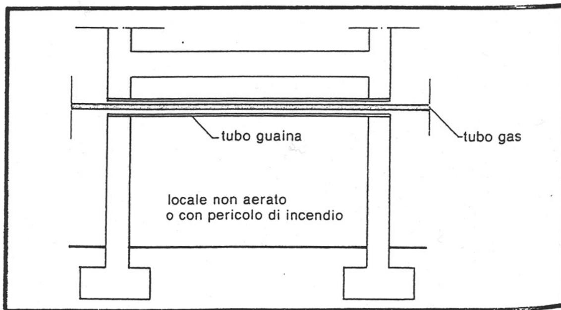
**Fig. 5** – Passaggio di un tubo del gas entro un tubo guaina.
