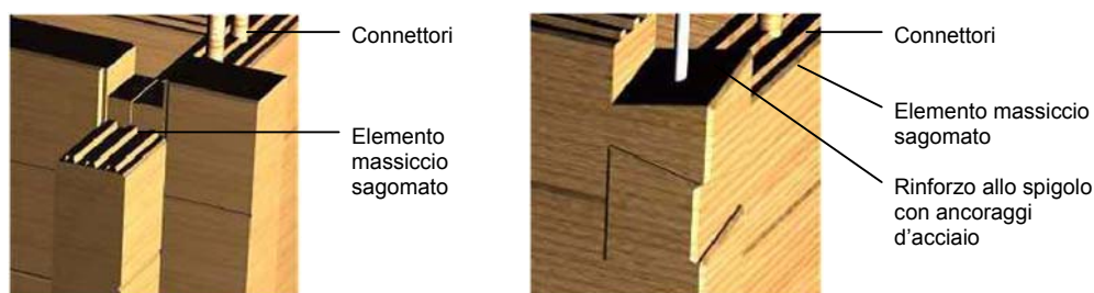
Figura 3: Altri tipi di collegamenti allo spigolo per il sistema costruttivo massiccio
