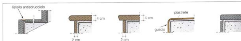
Fig. 36 - Tipi di sagomature di scalini.
