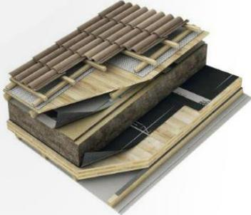
**Tetto inclinato con struttura in pannelli massicci, ventilato con vano tecnico**
