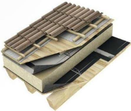
**Tetto inclinato ventilato con struttura in travi a vista**
