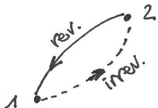
$$\oint \frac{\delta Q}{T} = \int_1^2 \frac{\delta Q}{T} + \int_2^1 \left(\frac{\delta Q}{T}\right)_{\text{int rev.}} = \int_1^2 \frac{\delta Q}{T} - \int_1^2 \left(\frac{\delta Q}{T}\right)_{\text{int rev.}} \leq 0 \Rightarrow$$
