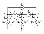
Sia il generatore di tensione  $E_1$  sia il generatore di tensione  $E_2$  impongono due vincoli alle tensioni di nodo. Il primo vincolo è dato da  $V^{(1)} = E_1$ , mentre il secondo da  $V^{(3)} = V^{(2)} + E_2$ . Delle tre tensioni di nodo, solo una è un'incognita del problema. Con queste osservazioni, si può scrivere
