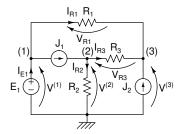
Si noti che il generatore di tensione  $E_1$  impone il vincolo  $V^{(1)} = E_1$ . La tensione  $V^{(1)}$  è quindi nota e può essere non considerata come incognita del problema. Per quanto riguarda tensione e corrente sulle resistenze si ha
