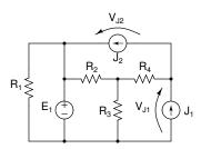
Con riferimento al circuito di figura si assumano i seguenti valori:  $R_1=R_2=R_3=2\,\mathrm{k}\Omega,\,R_4=4\,\mathrm{k}\Omega,\,E_1=12\,\mathrm{V},\,J_1=2\,\mathrm{mA},\,J_2=2\,\mathrm{mA}.$
