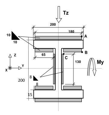
Una trave HEB 200 B è saldata a sbalzo su una parete verticale con cordoni d'angolo come indicato in figura. Assumendo che le dimensioni dei cordoni riportate siano quelle efficaci per la resistenza, si esegua la verifica statica sulla saldatura sollecitata dai carichi di taglio e flessione nel piano XZ in corrispondenza dei punti indicati come A, B e C
