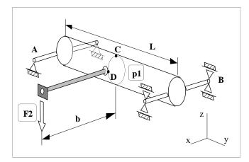
Un serbatoio di gas di forma cilindrica e raggio esterno r0, dotato di fondi piani, è disposto orizzontalmente come in figura e supportato isostaticamente in corrispondenza dei fondi A e B. Considerando dapprima la sola pressione interna p1 e l'ipotesi di recipiente in parete sottile, si calcoli lo spessore t della parete cilindrica del serbatoio adottando l'ipotesi di Guest, ipotizzando un materiale con tensione di snervamento σs ed un coefficiente di sicurezza νs.
