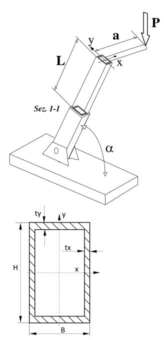
Il braccio telescopico rappresentato in figura è sottoposto ad un carico verticale P agente all'estremità con uno sbraccio pari ad a. Sapendo che il braccio forma con l'orizzontale un angolo  $\boldsymbol{\alpha}\,$  , si calcoli il valore del coefficiente di sicurezza statico nel punto più sollecitato della sezione 1-1, considerata come incastro perfetto.
