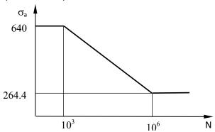
Nel caso in esame, K<sub>t</sub>=K<sub>f</sub>=1, mentre K<sub>a</sub> e K<sub>b</sub> si devono calcolare dai relativi diagrammi.
