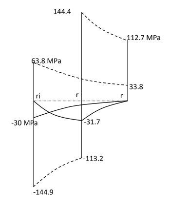
Si determini lo stato tensionale creato in un recipiente a doppia parete senza fondi dalla presenza di una pressione interna pi e dal forzamento delle due pareti con una interferenza diametrale i\u00f3.
