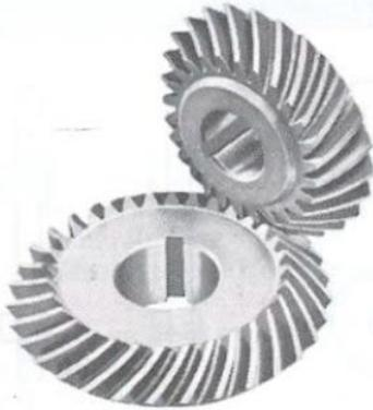
Coppie di ruote coniche: a) con denti a spirale, b) ipoidi, con assi di rotazione giacenti in piani ortogonali ma non concorrenti.
