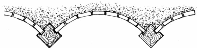
*Solaio con travi di legno e voltine: disposizione a rombo*
