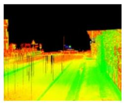
Noventa Vicentina. Visualizzazione della nuvola di punti, con mappa di riflettanza in modalità Hue. Il punto di vista è quello dello scanner tridimensionale in una stazione di ripresa.
