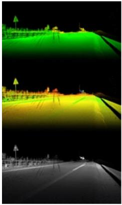
Noventa Vicentina. Sopra: visualizzazioni del modello tridimensionale, ottenuto da Laser Scanner 3D: senza dato di riflettanza e con mappa di riflettanza, nelle modalità Hue e Grey.
