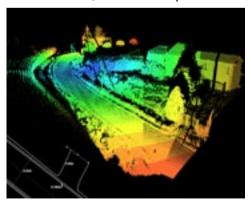
Sandrigo. Visualizzazione in nuvola di punti del modello tridimensionale del apparato strada-contesto, prima restituzione dell'andamento planimetrico in ambiente CAD.
