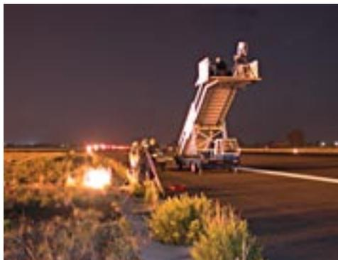
Stazione-tipo: lo scanner Cyrax 2400 installato sopra la scala e la stazione totale TPS1102, a bordo pista, impiegata nella battitura dei target.
