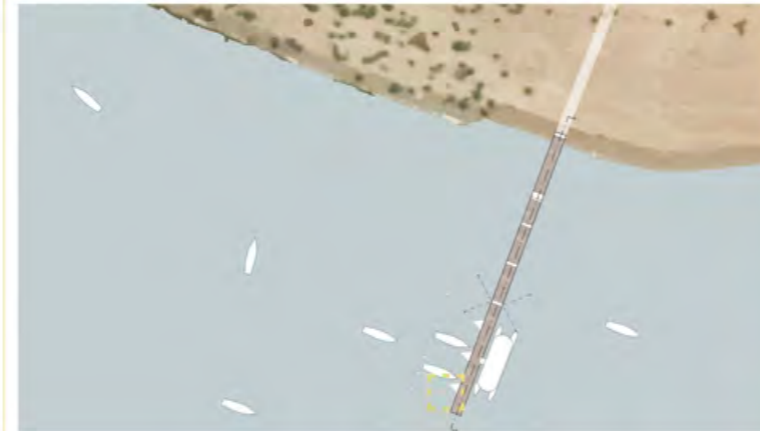
Piano scala 1:500. Molo legno. Il legno di Eucalipto, Acciaio inox e galleggiante in Polietilene.
